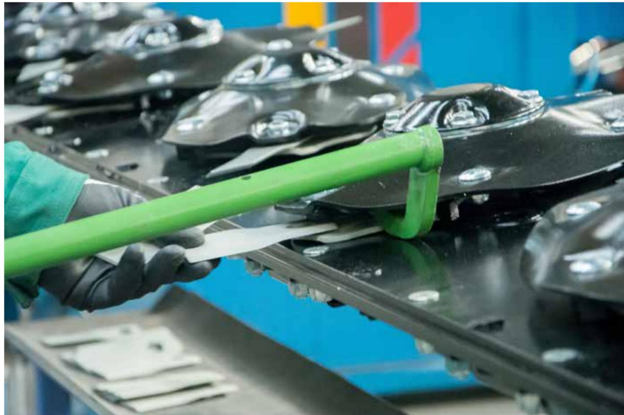
Toutes nos faucheuses possèdent un remplacement rapide et facile des couteaux (120mm) avant/arrière du lamier grâce à une clé de remplacement.
