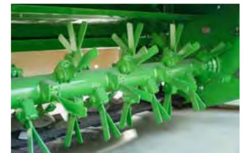
Les conditionneurs avec des dents en acier résistant à l'usure et des amortisseurs en caoutchouc garantissent un fonctionnement plus sûr et sans entretien.
