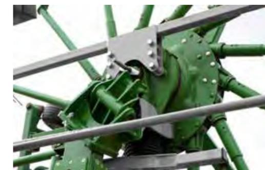
Un entraînement fiable assure une transmission parfaite de la force par des roues dentées et des arbres de transmission
