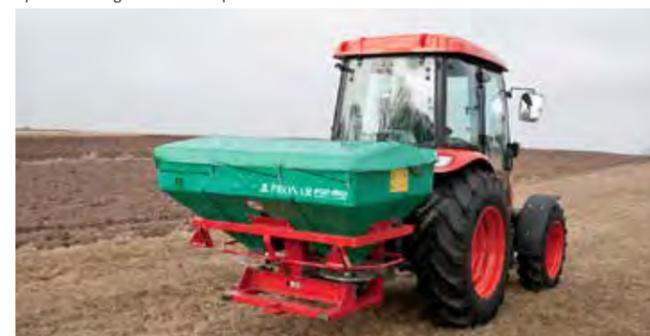
Disques de diffusion en tôle d'acier résistante à la corrosion
