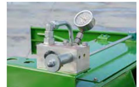
La décharge hydropneumatique du lamier protège l'appareil contre les dommages.
