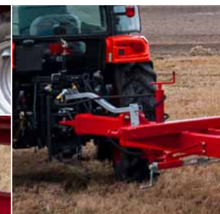
T654/2 - Flèche rigide pour connection avec attelage supérieur du tracteur
