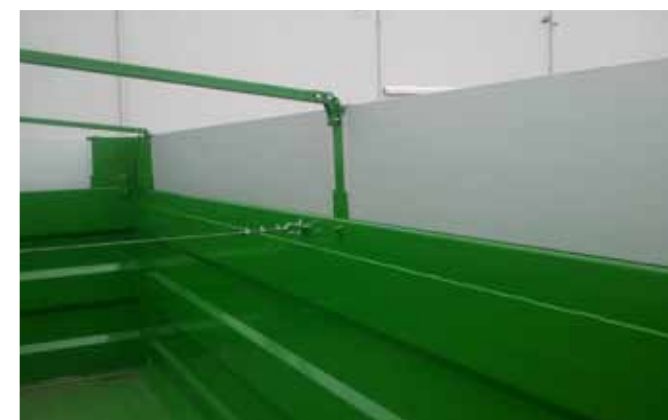
Parois 1500 mm + rehausses 400 mm en aluminium
