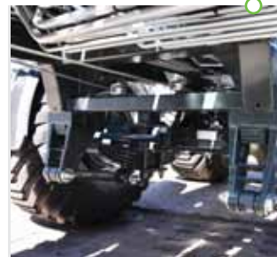
Suspension tandem sur ressorts paraboliques
