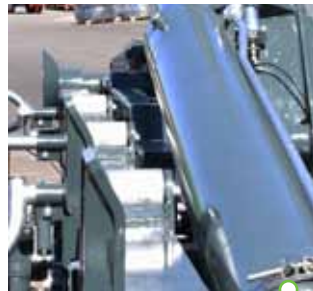
Chassis avec des rouleaux aiglant le mouvement du caisson
