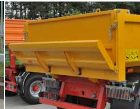
Porte hydraulique arrière 450 mm et porte arrière pendulaire avec possibilité de l'ouverture à droite
