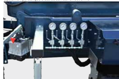
Système hydraulique d'essieu suiveur directionnel
