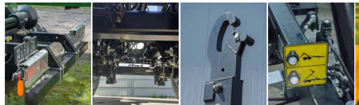
Pare-choc arrière Suspension sur ressorts paraboliques Crochet avec blocage de conteneur Réglage automatique de fonction bennage/basculement
