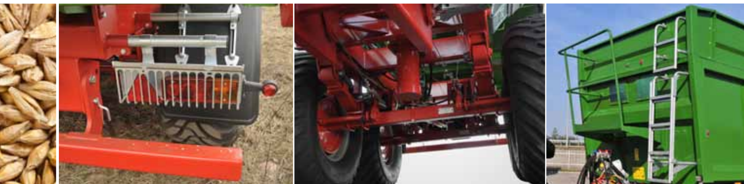
L'éclairage arrière de la remorque est protégé contre les dommages avec des grilles spéciales
