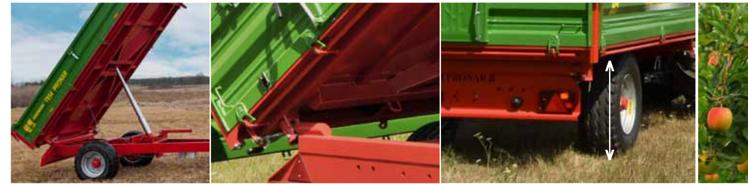
Système de bennage sur 3-côtés avec vérin télescopique avec une suspension articulée
