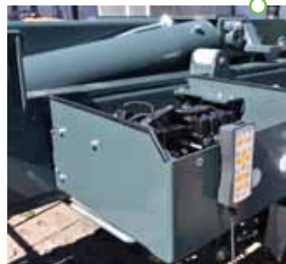
Système hydraulique central avec commande électrique
