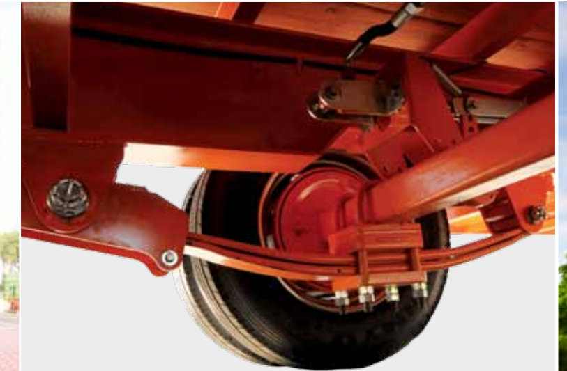
Suspension tandem sur ressorts paraboliques
