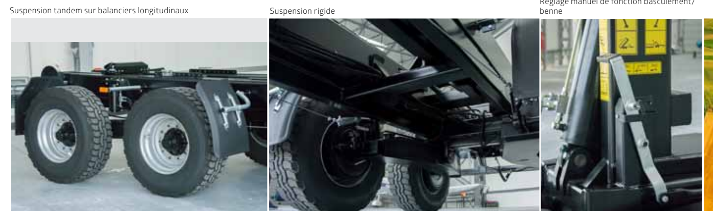
Suspension tandem sur balanciers longitudinaux
