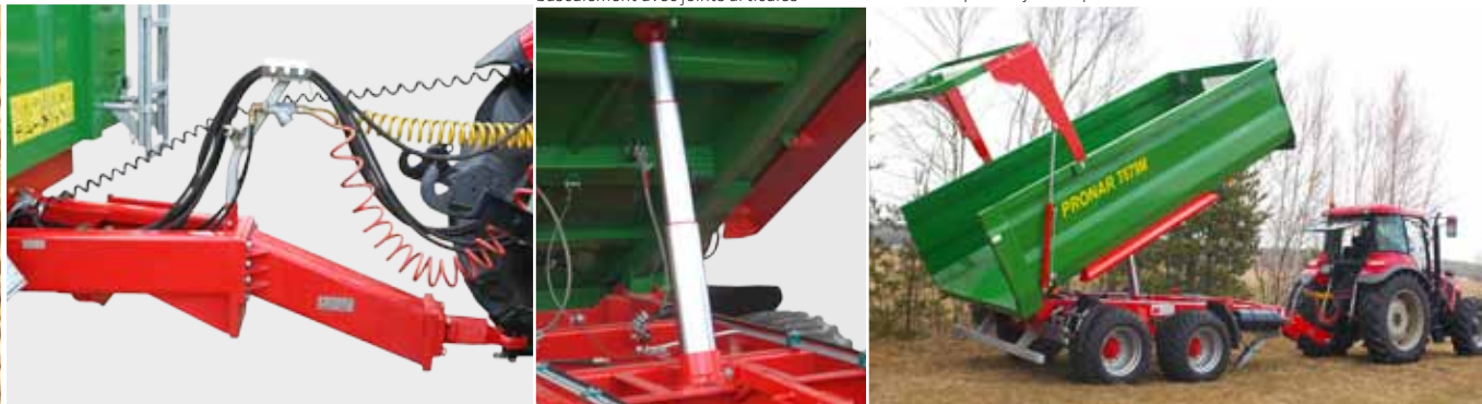
Le vérin télescopique de basculement avec joints articulés
