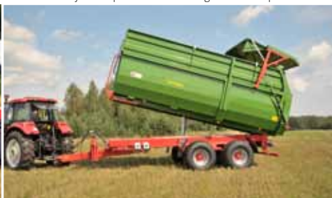
T700 - Paroi hydraulique avec verrouillage automatique
