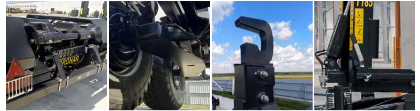
T185 - pare-choc arrière Suspension sur des balanciers Crochet sans blocage de conteneur Réglage manuel de fonction bennage/basculement
