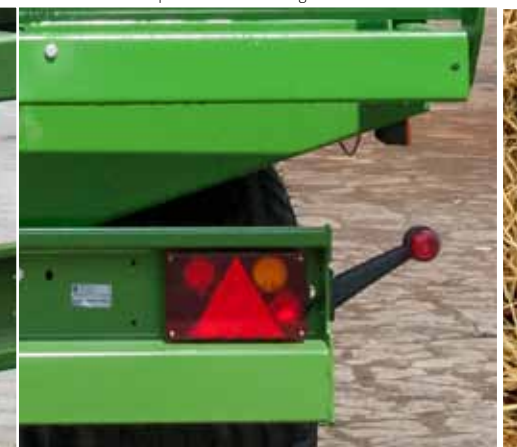
Installation électrique 12V avec feux de gabarit latéraux
