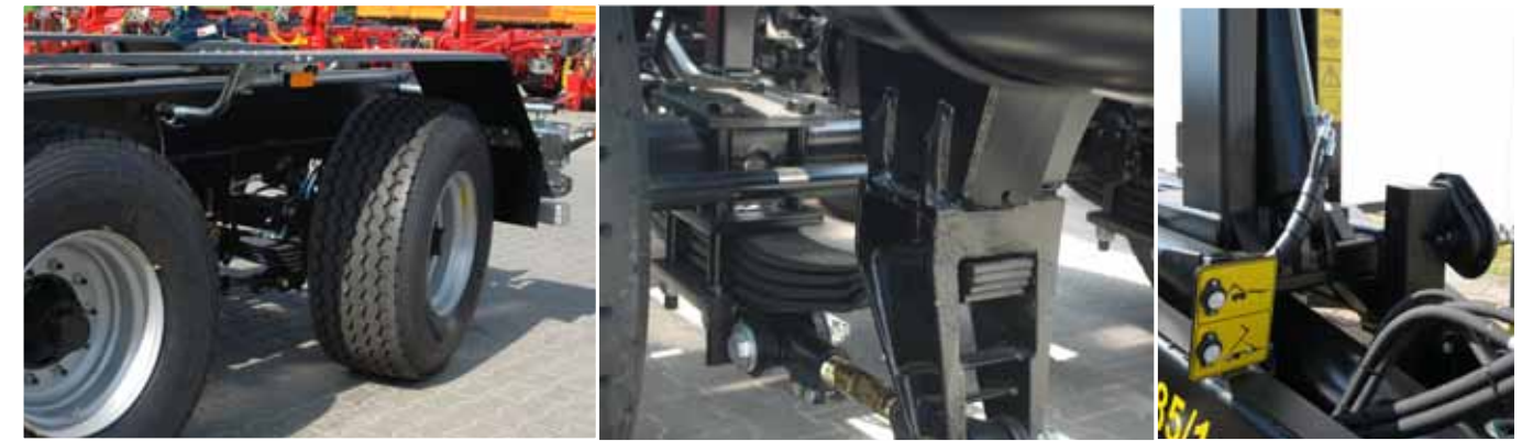
Suspension tandem sur ressorts paraboliques
