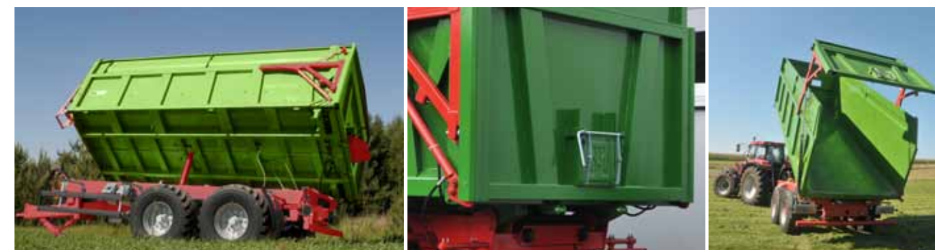
Basculement sur le côté droit sous un angle de 45° dans le T669/1
